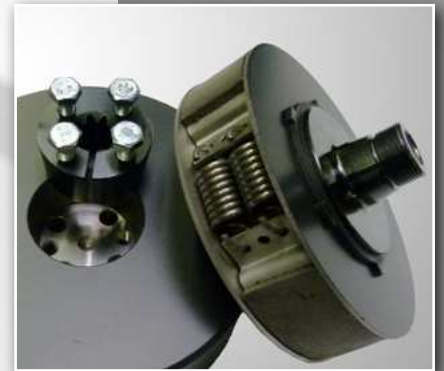
Fliehkraftkupplung mit Einschraubnabe zum Motor
